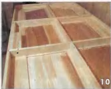
В местах установки замков, петель и ручек вклеены дополнительные бруски
