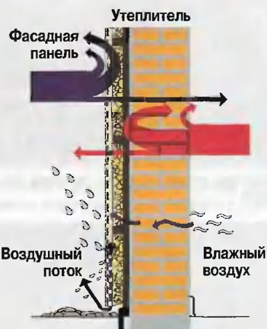
Навесная вентилируемая фасадная система — оптимальное решение с точки зрения строительной физики
