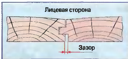
Рис. 4. Узел стыковки шпунтованных досок
